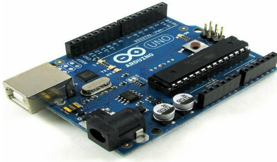
Fig. 3: An Arduino microcontroller – Arduino Uno
